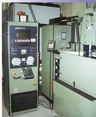
Náhrada čtečky GHIEMMETTI FER202 u drátořezu se systémem AGIEMATIC
