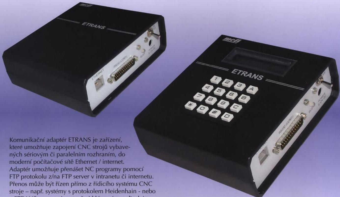
Komunikační adaptér ETRANS je zařízení, které umožňuje zapojení CNC strojů vybavených sériovým či paralelním rozhraním, do moderní počítačové sítě Ethernet / internet.
