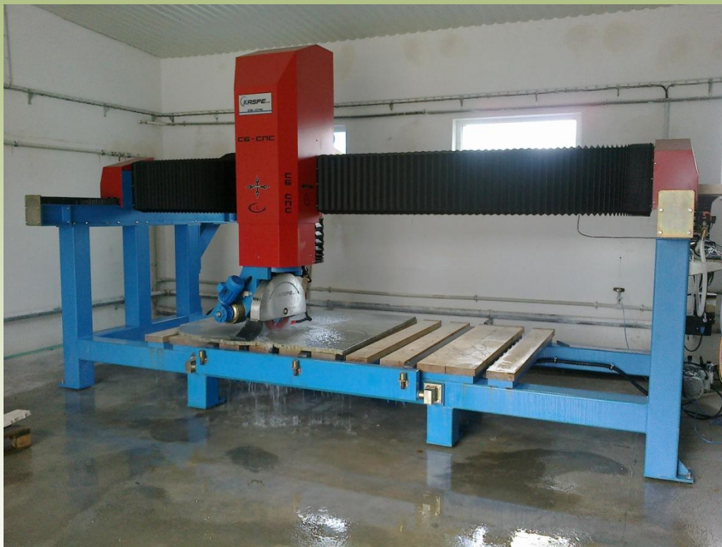
Stroj na řezání mramoru, žuly, pískovce apod. (osy X, Y, Z, naklápění a rotace pily)
